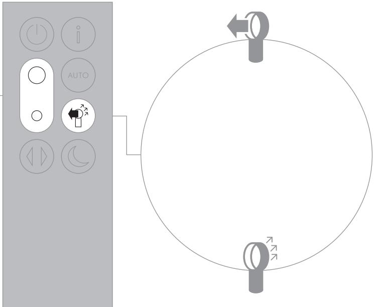
ستتم تنقية الهواء باستمرار، سواء أكان الهواء قد تم تعين تدفقه من الأمام أم من الخلف.
